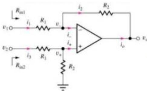
$$v_O = v_- - i_2 R_2 = v_- - i_1 R_2$$
